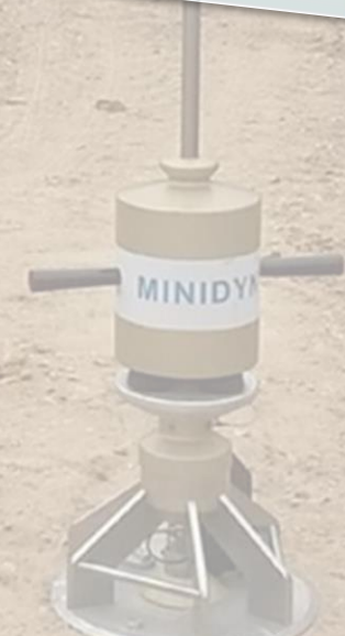
Minidyn bien plaquée au sol pendant l'essai grâce à l'appui sur la tige
