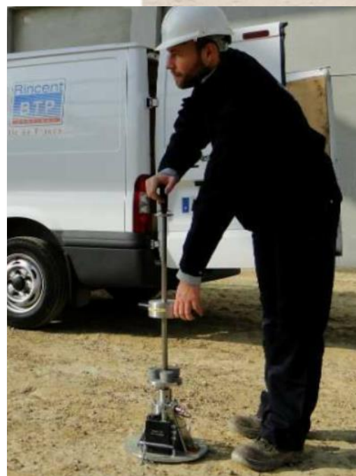
Minidyn bien plaquée au sol pendant l'essai grâce à l'appui sur la tige
